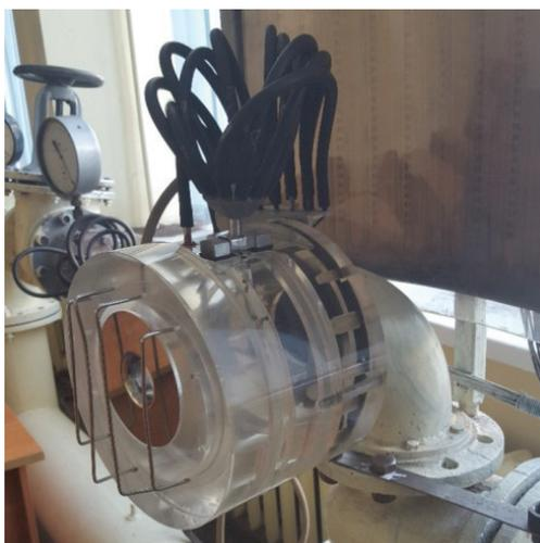
**Рис. 13.** Стенд для исследования истечения газа через сопло
