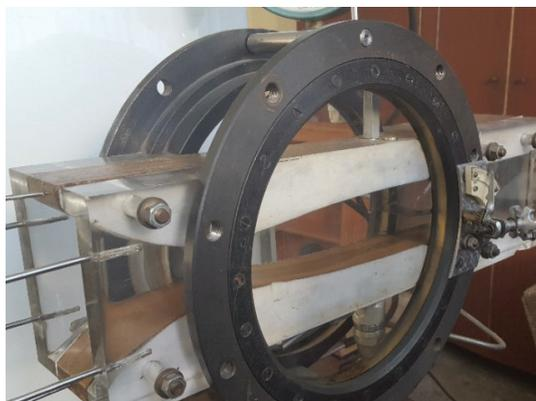
**Рис. 15.** Стенд для исследования обтекания клина сверхзвуковым потоком
