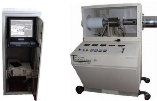
Рис. 5. Газотурбинная силовая установка MiniLab
