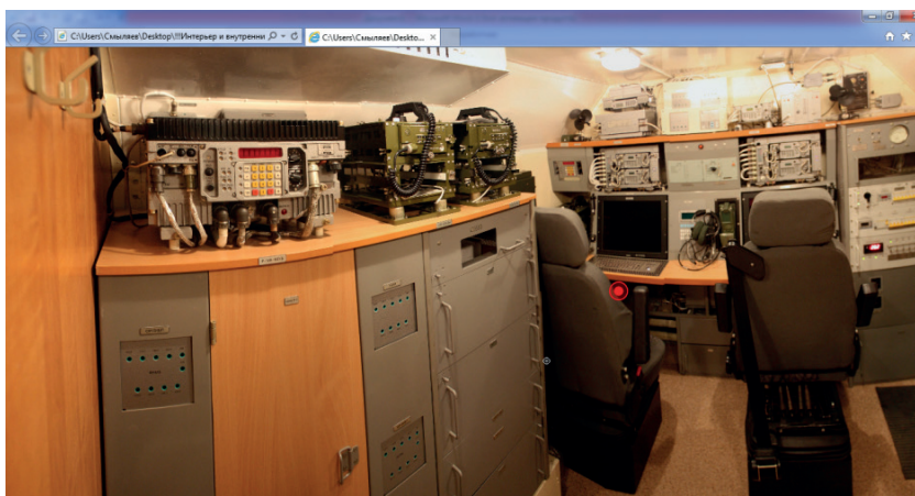
Рис. 3. Вид внутреннего устройства КШМ Р-142Т со средствами связи
