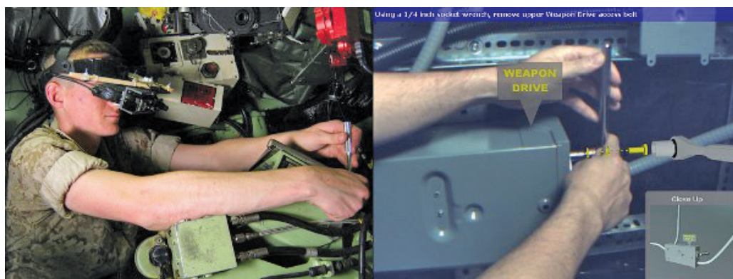
Рис. 7. Установка танкового орудия согласно указаниям системы дополненной реальности
